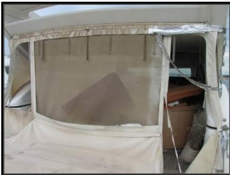
Slika 14. Potpuno uništene tende krmenog dijela za putnike
