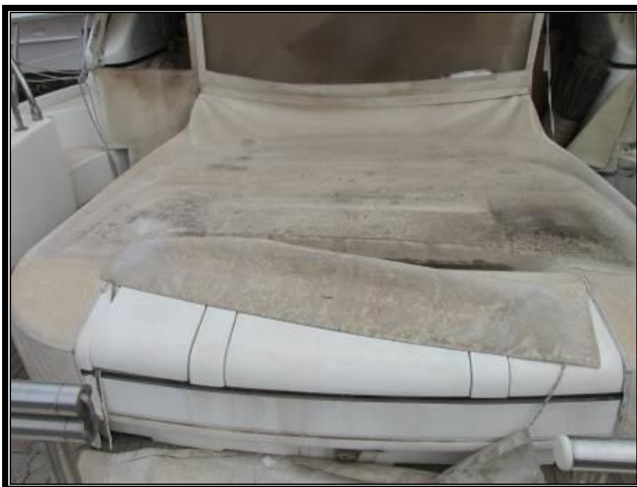
Slika 12. Krmani prostor za putnike zapušten i oštećen neodržavanjem
