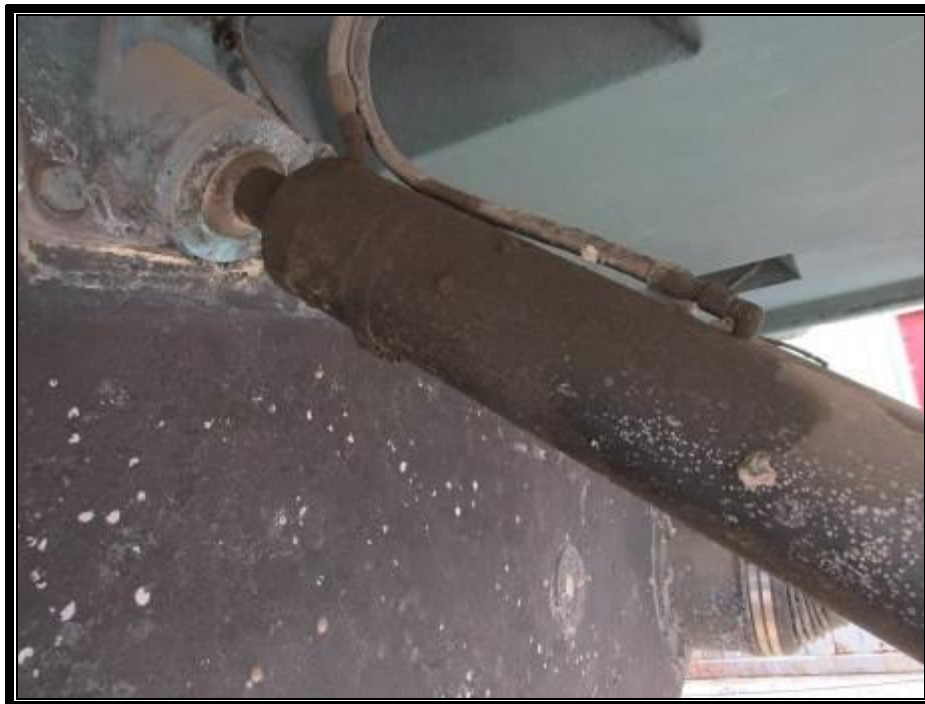
Slika 6. Dotrajala podvodna upravljačka hidraulična oprema
