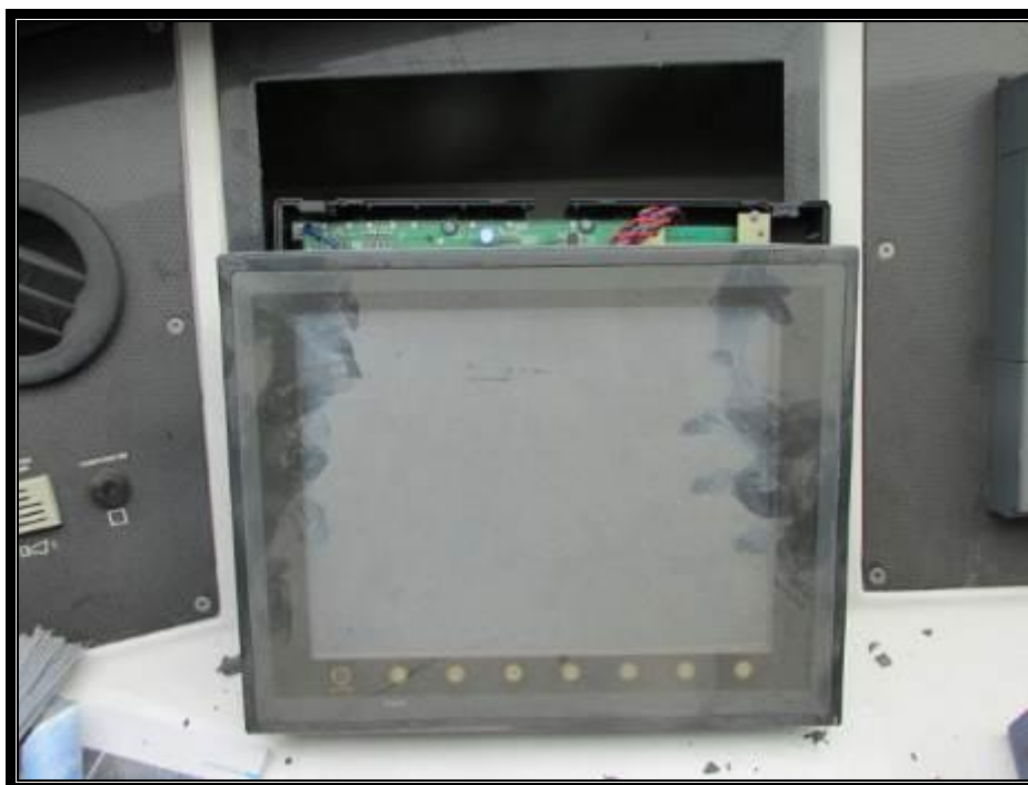
Slika 26. Oštećeni instrumenti u kokpitu
