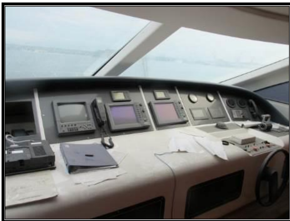
Slika 17. Upravljačko mjesto u kabini – kokpit s dotrajalom opremom
