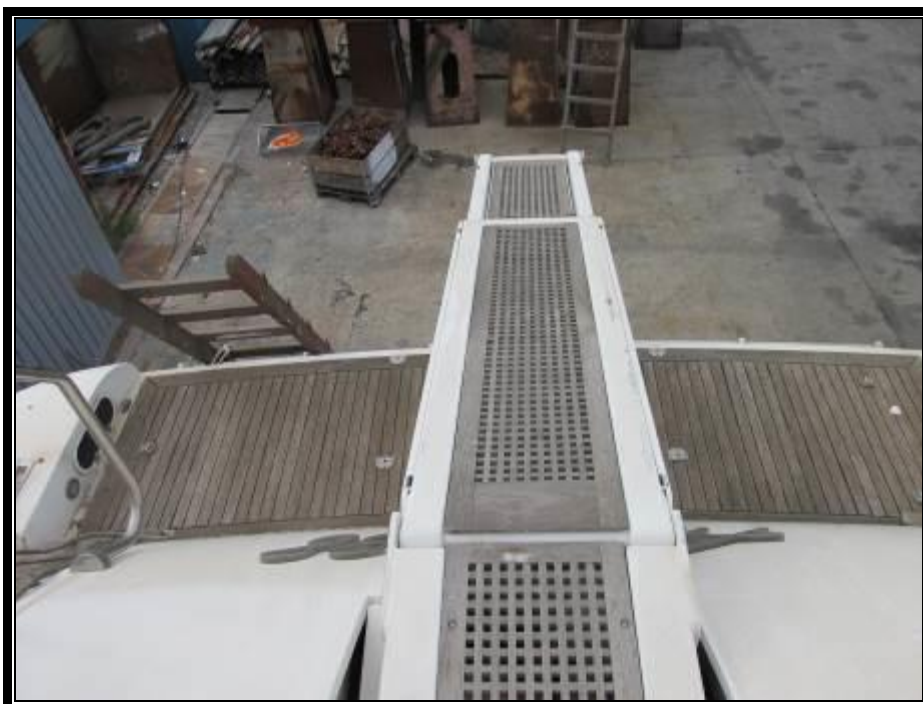
Slika 13. Oštećenje TEAK obloge platforme i neispravna passarella
