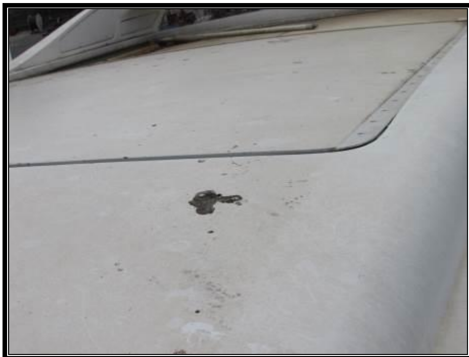
Slika 15. Više oštećenje stakloplastike nadgrada
