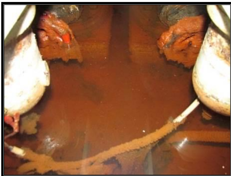
Slika 41. Naplavljeni bilge ispod motora – korodirana oprema brodskih sustava
