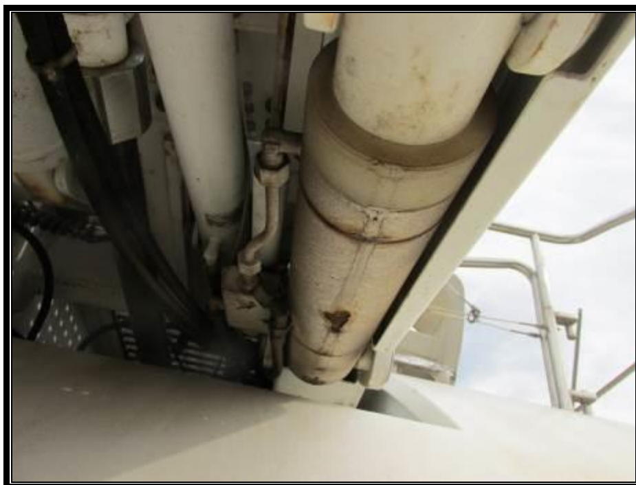
Slika 29. Korozijom oštećana hidraulika passarelle
