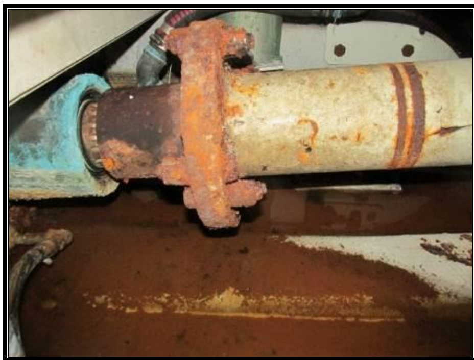
Slika 34. Naplavljeni bilge ispod motora – korodirana osovina
