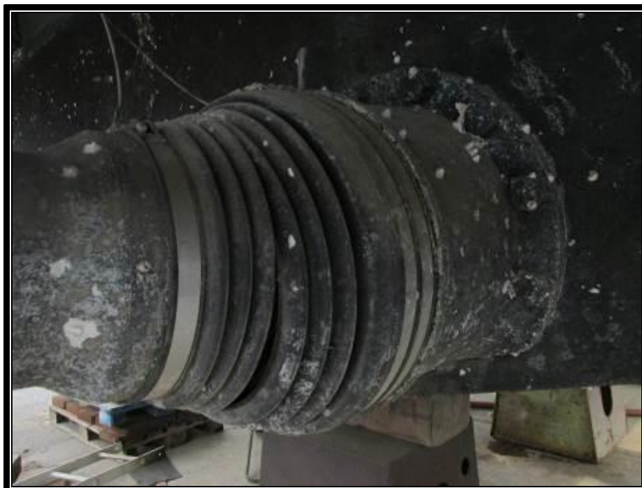
Slika 7. Dotrajale i iskidane manžetne pogonskih osovina
