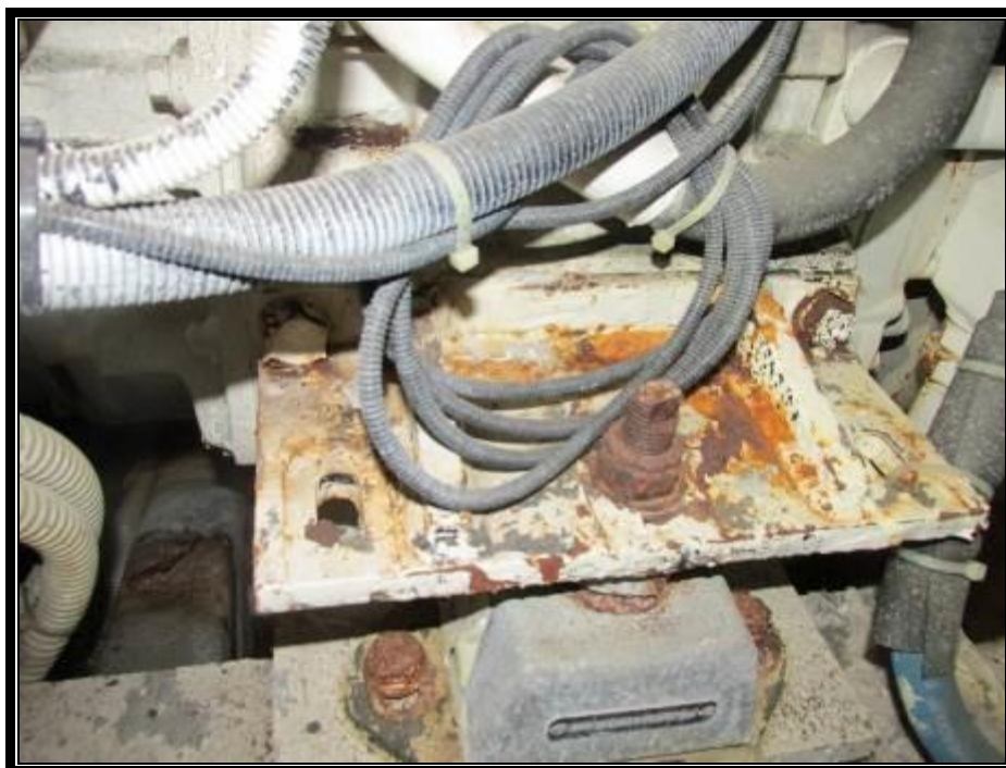
Slika 38. Korozijska pogonskih motora uzrokovana naplavlivanjem
