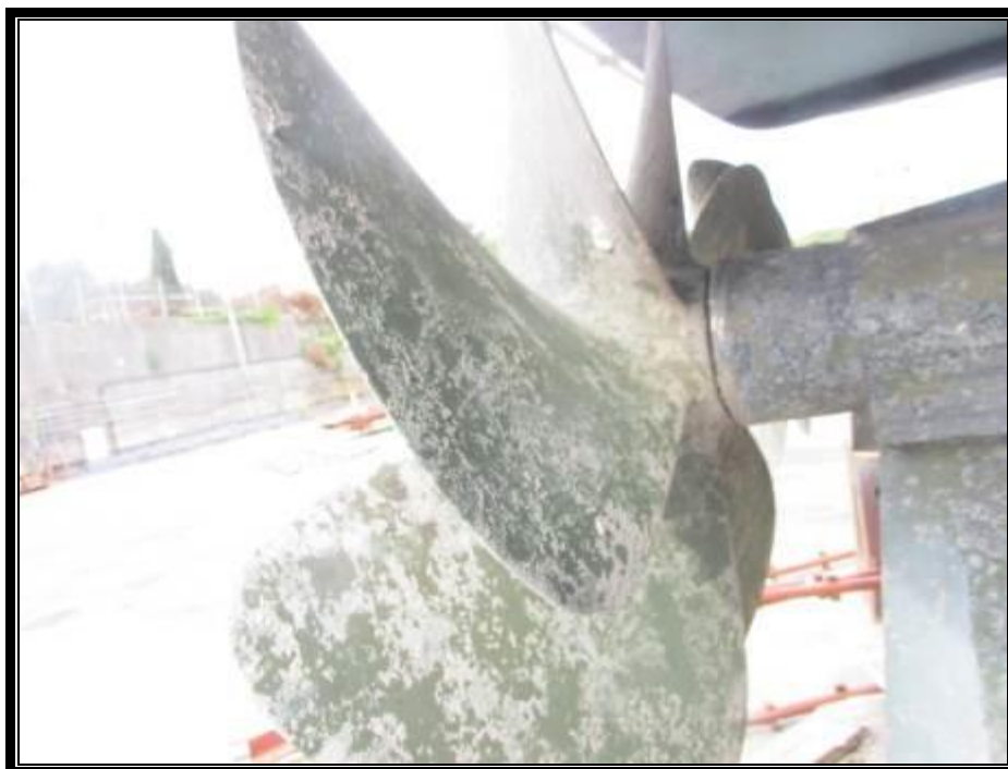
Slika 8. Pogonski propeleri oštećeni površinskom korozijom i kavitacijom
