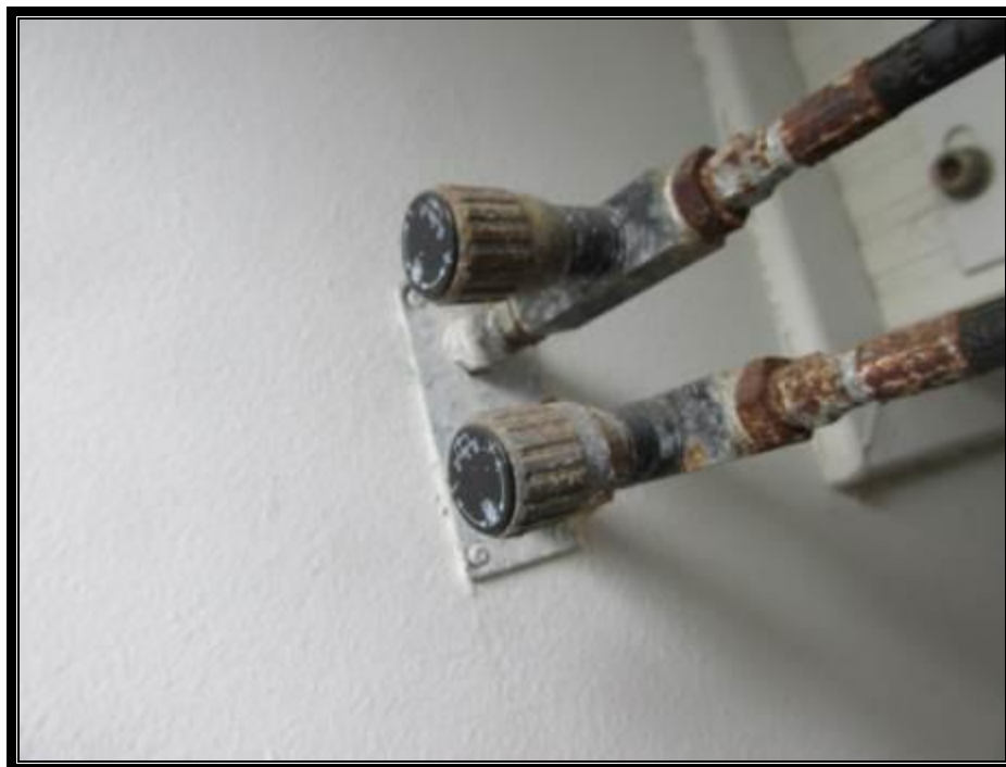
Slika 36. Korodirane instalacije brodskih sustava
