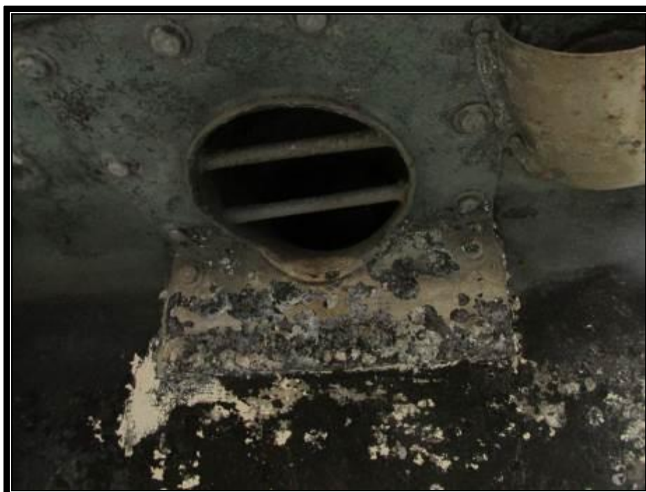
Slika 9. Više oštećenja i dotrajalosti podvodnih dijelova opreme trupa
