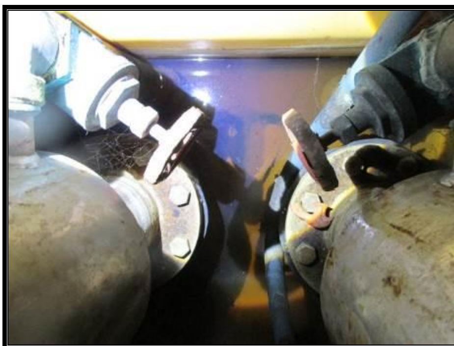
Slika 39. Potpuno naplavljena strojarnica–korodirane instalacije brodskih sustava
