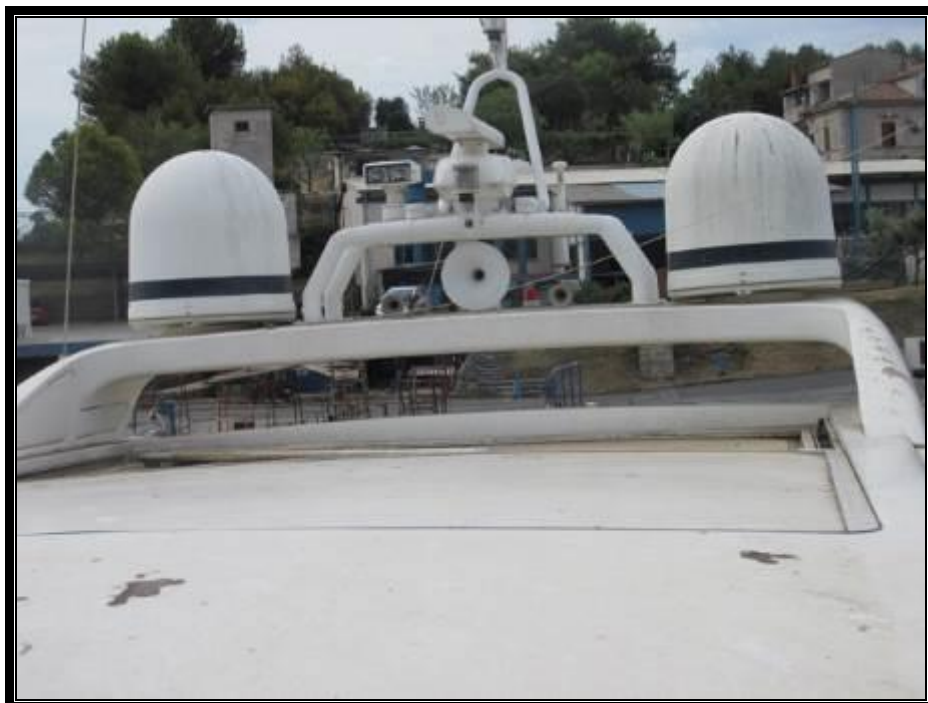
Slika 18. Antene navigacijskih uređaja – upitne ispravnosti, dotrajale
