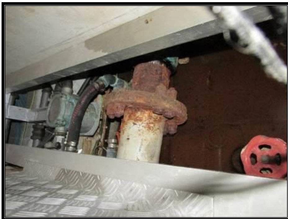
Slika 40. Naplavljeni bilge ispod motora – korodirana osovina
