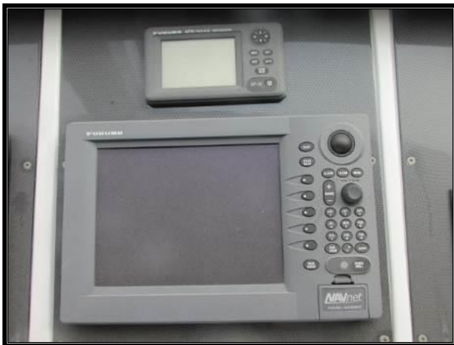
Slika 27. Zastarjela navigacijska oprema upitne ispravnosti
