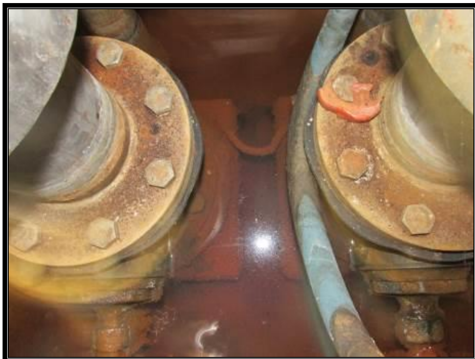
Slika 35. Potpuno naplavljena strojarnica–korodirane instalacije brodskih sustava
