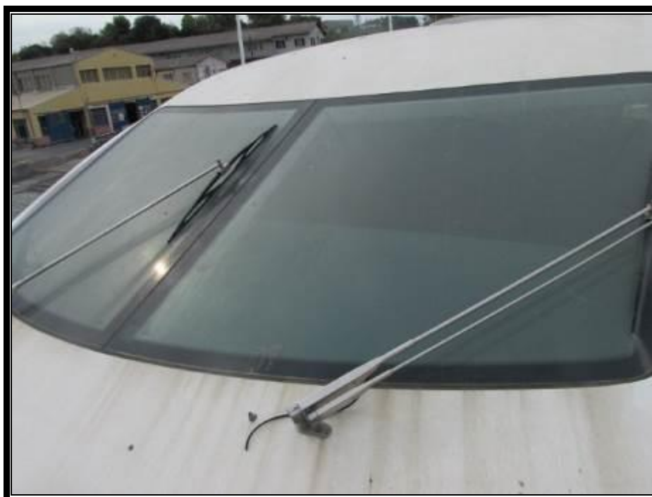
Slika 11. Vjetrobranska stakla oštećena suncem i dotrajali brisači
